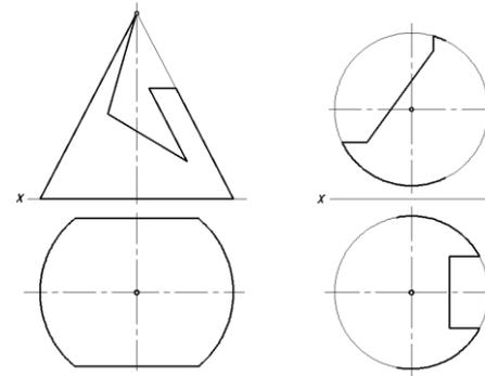
Построить развертку цилиндрической поверхности методом раскатки
