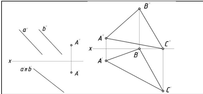
Определить положение заданных плоскостей относительно плоскостей проекций. Построить проекции треугольников **ABC**, расположенных в этих плоскостях
