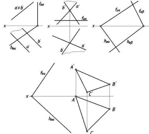
Построить проекции точек пересечения прямой **a** с заданными плоскостями. Определить видимость прямой относительно плоскостей.
